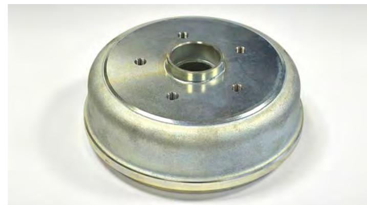
Bremstrommel Indespension 203 x 50 mm, Knott Typ, M12, 5 Loch LK: 112 mm
