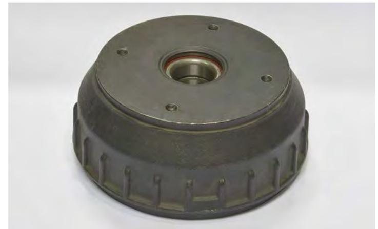
Bremstrommel Alko 200 x 57 mm, M 12 - 4 Loch 139,7 mm Lochkreis für Typ 2051, inkl. Radlager 72mm
