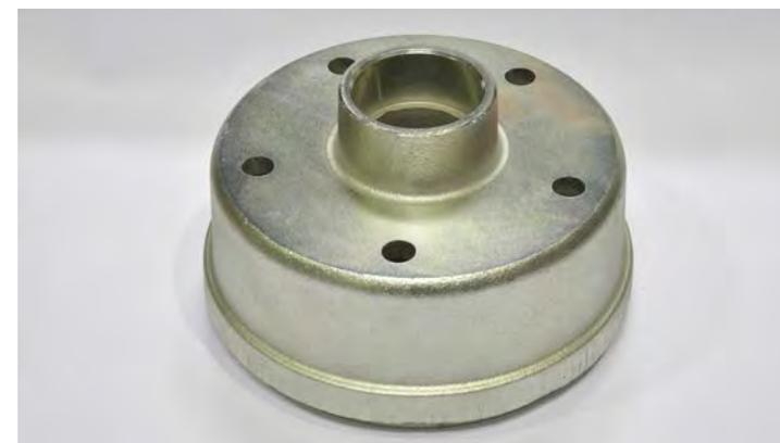
Bremstrommel Indespension 200 x 65 mm, Knott Typ, M16, 5 Loch LK: 165,1 mm
