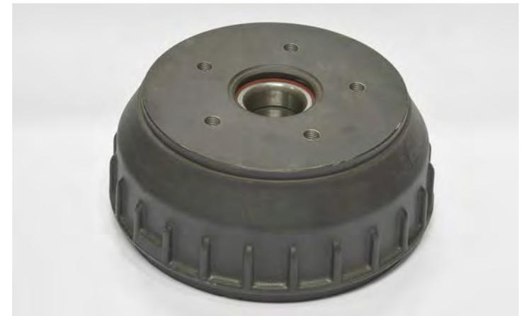
Bremstrommel Alko 200 x 57 mm, M 12 - 5 Loch 112 mm Lochkreis für Typ 2051, inkl. Radlager 72mm
