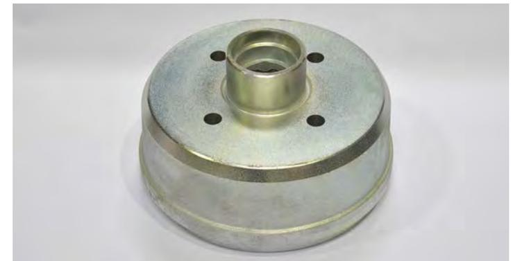
Bremstrommel Indespension 160 x 47 mm, Alko Typ, M12, 4 Loch LK: 100 mm
