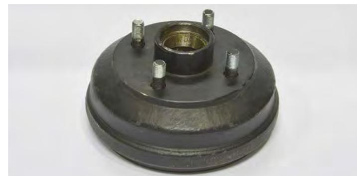
Bremstrommel Knott/Avonride C 160 x 47 mm, M12 - 5 Loch LK: 100 mm, inkl. Radlager
