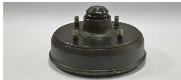
Bremstrommel Knott/Avonride R 200 x 52 mm, M12 - 4 Loch LK: 139,7 mm, inkl. Radlager
