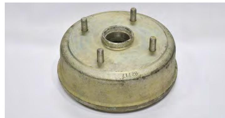
Bremstrommel Indespension 200 x 50 mm, Alko Typ, M12, 4 Loch LK: 139,7 mm
