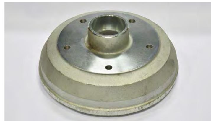
Bremstrommel Indespension 250 x 65 mm, Knott Typ, M16, 5 Loch LK: 165,1 mm
