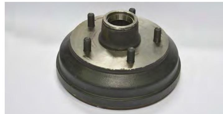
Bremstrommel Knott/Avonride V 250 x 59 mm, M16 - 5 Loch LK: 165,1 mm, inkl. Radlager
