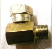
Winkel Adapter zum Anschluss des Hydraulikschlauches
